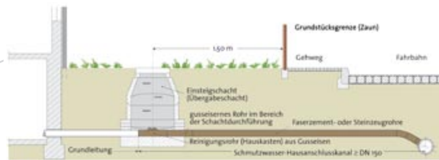
Abwasserentsorgungsleitung – Reinigungsrohr außerhalb des Gebäudes
