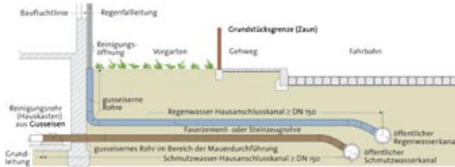
Abwasserentsorgungsleitung – Reinigungsrohr im Gebäude
